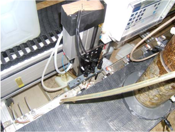
Bild 12: Auffanggefäße für Messungen
